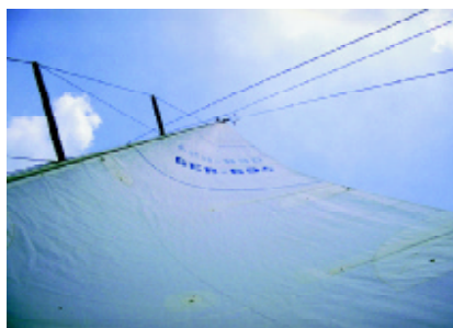
Großsegel durch Mastbiegung flach und offen getrimmt
